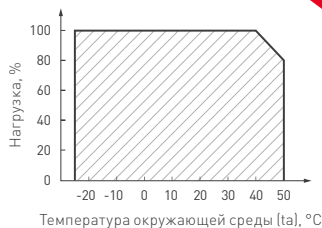
Рис. 3. Максимальная допустимая нагрузка, % от мощности источника
