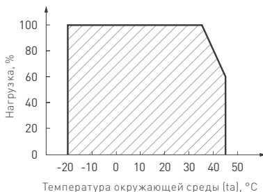
Рис. 2. Максимальная допустимая нагрузка, % от мощности источника
