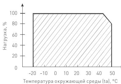
Рис. 2. Максимальная допустимая нагрузка, % от мощности источника.
