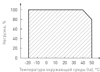
Рис. 2. Максимальная допустимая нагрузка, % от мощности источника.
